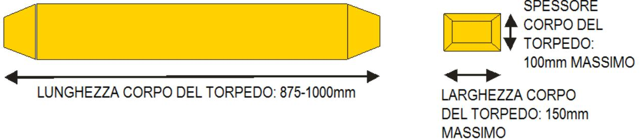
Corpo del Torpedo (parte galleggiante)
